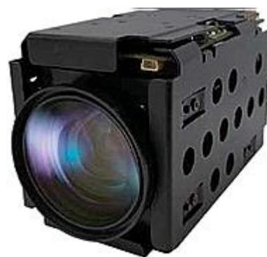
HD CCTV сигнал передается непрерывным цифровым потоком по коаксиальному кабелю. Максимальное расстояние до приемника HD-SDI сигнала составляет 100 метров. В случае необходимости передачи цифрового видеосигнала на большее расстояние возможно применение репитера HD-SDI.
