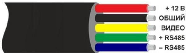
Схема подключения видеокамеры VB21S-R36
