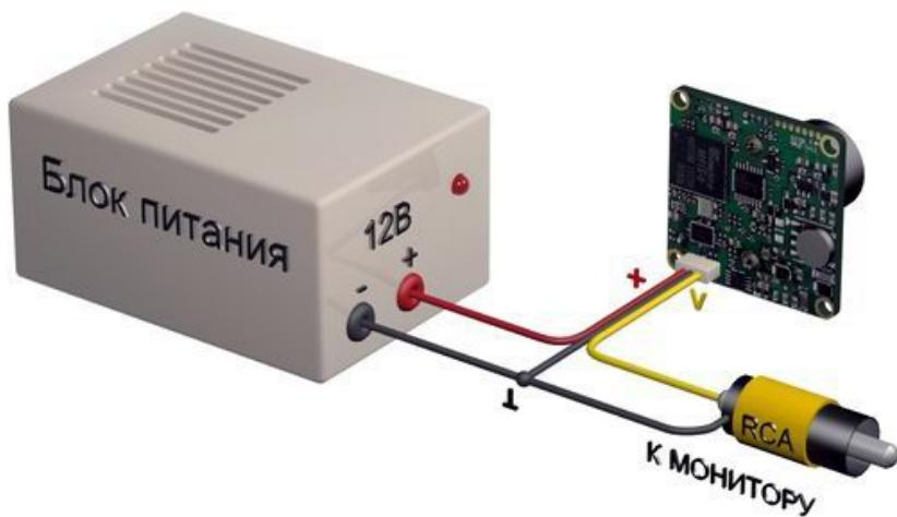
Схема подключения видеокамеры VM32BSHRX-VFA49
