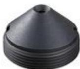
В стандартном исполнении видеокамеры установлен микро объектив Р типа с фокусным расстоянием 3.7 мм и относительным отверстием F2.0 Возможные варианты оптики: Плоский объектив 3.4 (100°), 3.7 (90°); усеченный конус 3.7 (90°), 5.0 (60°); полный конус 2.8 (120°).
